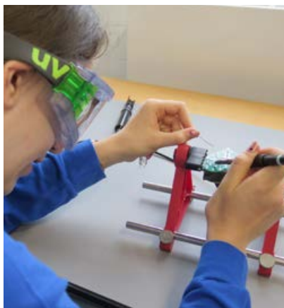
Millimeterarbeit: Praktikantin Anna-Maria Pixius verlötet einen Widerstand in einem elektronischen Blinkherz mit 24 Leuchtdioden.
