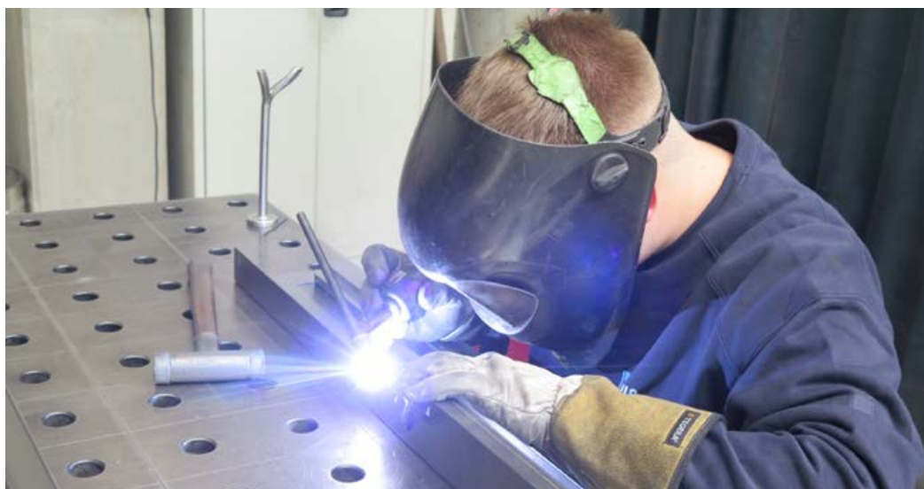
Paul Marxen, Auszubildender zum Konstruktionsmechaniker der brosius GmbH, beim sogenannten WIG-Schweißen (Wolfram-Inertgasschweißen).
