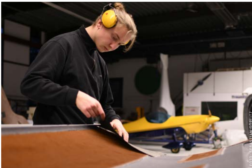
Sebastian Görlitz arbeitet am Innenlaminat einer Tragflächenhälfte. Im Hintergrund ein flugfertiges Ultraleichtflugzeug des Modells Silence Aircraft Twister.
